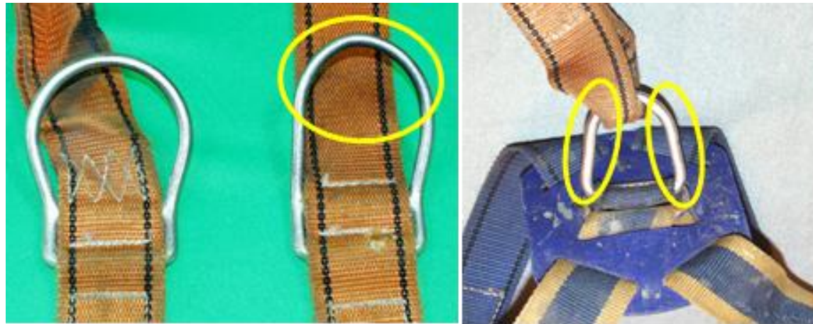
Uszkodzenia mechaniczne elementów metalowych
